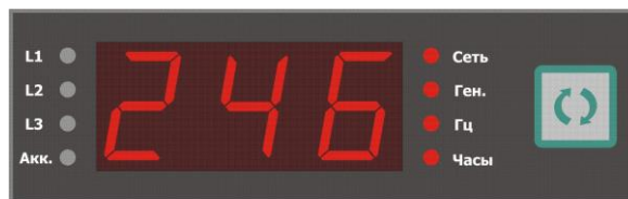
Рис. 5.7. Пример: значение параметра №114.
