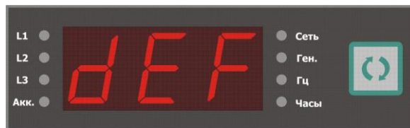
Рис. 5.8. Индикация установки параметров по умолчанию.
