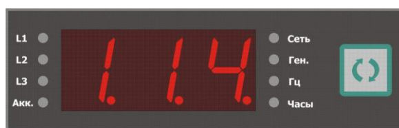
Рис. 5.6. Пример: параметр №114, доступный для редактирования значения.
